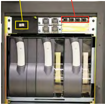
Interrupteur de marche/arrêt du rack
