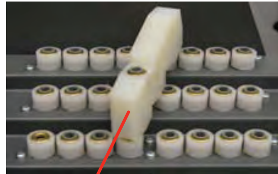
Collecteur optionnel pour la surveillance de plusieurs gaz.
